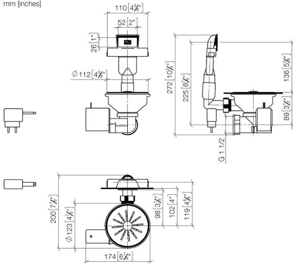
**Garniture d'écoulement et de trop-plein. Commande électrique - Nickel**
